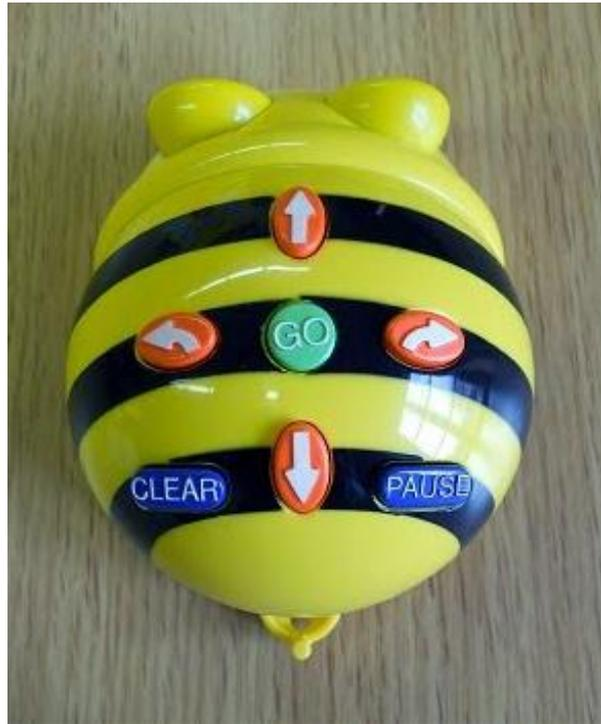
I tasti-freccia *avanti* e *indietro* fanno avanzare e indietreggiare Bee-bot in linea retta di 15 centimetri; i tasti-freccia *destra* e *sinistra* lo fanno ruotare intorno a un asse verticale, rispettivamente in senso orario e antiorario, di 90 gradi. La lunghezza del passo, come pure l'ampiezza dell'angolo di rotazione, sono misure fisse e abbastanza precise<sup>23</sup>.
